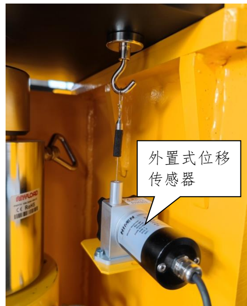
图 39、位移传感器安装示意
