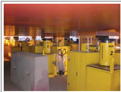
▲ 上海外高桥造船有限公司坞内巨型总段造船法工艺工程实例（6000吨重巨型总段）
