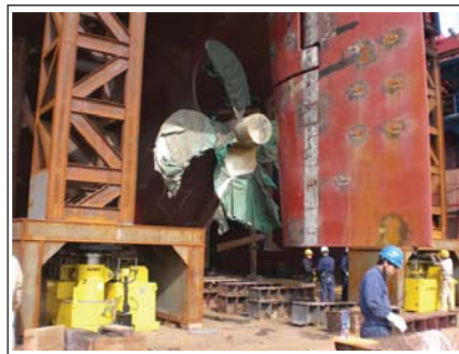
▲ RCA系列单台600吨自动型三维调整机在中船澄西船厂的浮船坞内使用
