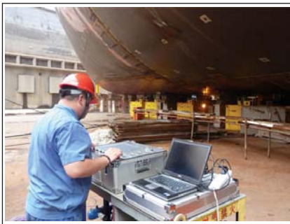
▲ RCA系列单台226吨自动型三维调整机在上海外高桥船厂的船坞内使用
