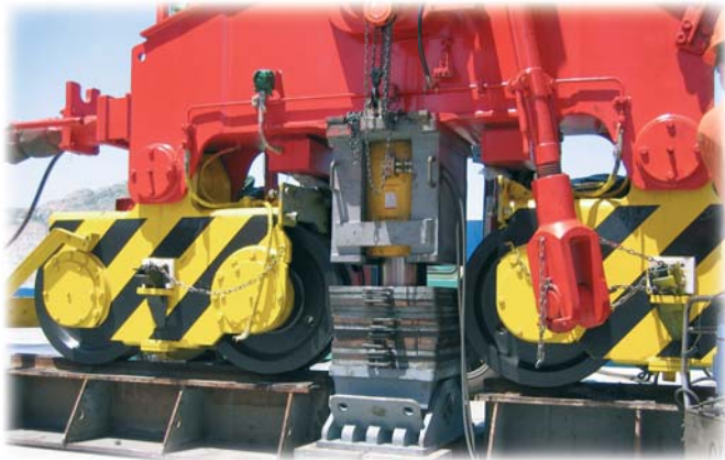
▲ RHD6008耐用型大吨位双作用液压油缸应用于重达2000多吨重型港口机械的顶升和转向
