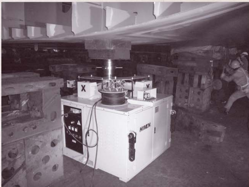
图为为公司创造了新效益的液压三维分段调整定位机 周洁 摄
